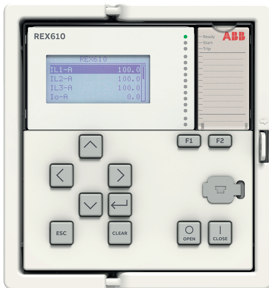
Rysunek 2: Przykładowy interfejs LHMI
